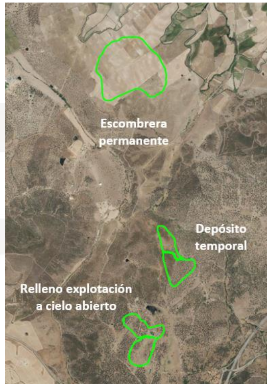
Figura 108. Situación de la escombrera permanente, el depósito temporal y el relleno de los huecos mineros en superficie
